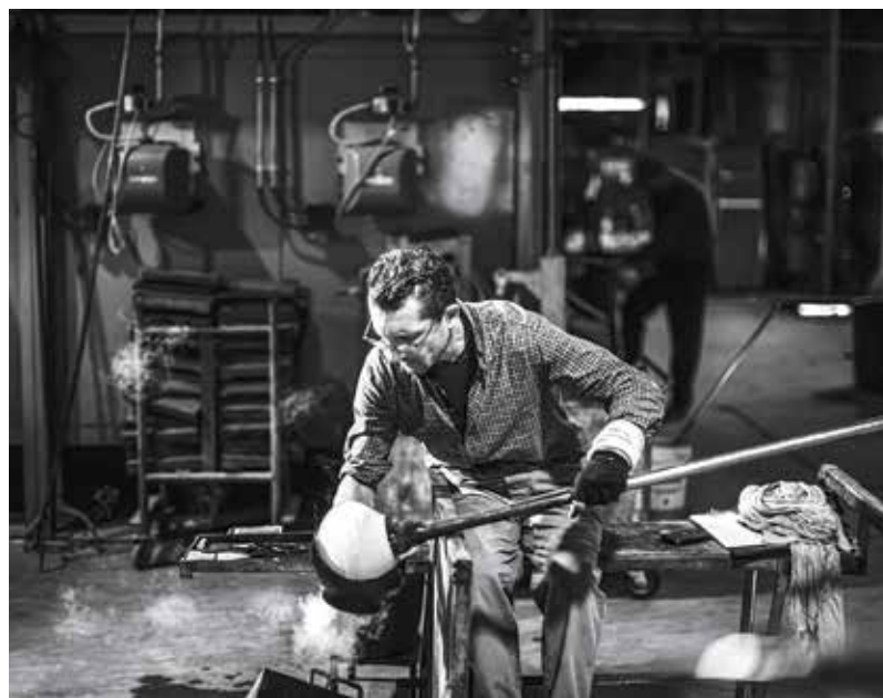
All'interno della fornace di Vetrofond artigiani specializzati realizzano i vetri delle lampade Foscarini. Preparazione della pasta vitrea prima della soffiatura a bocca nello stampo e (sopra) ricottura del vetro.
