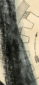
Fig. 252 - Pennelli magnetici sui denti degli indotti.
